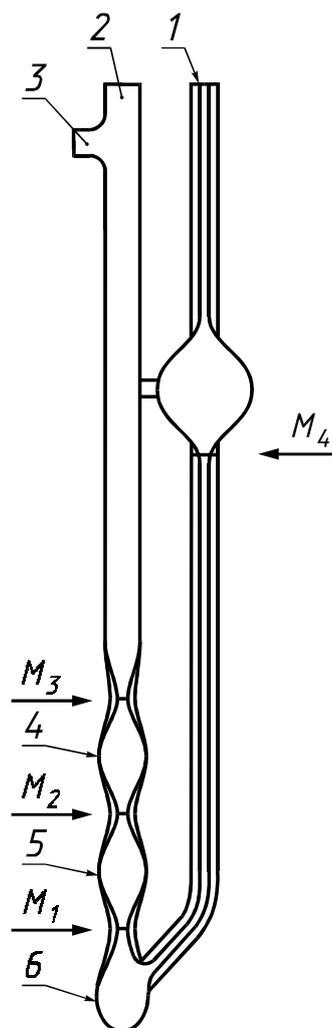
Рисунок А.6 — Вискозиметр типов ВНЖ, ВНЖТ (Канон-Фенске-Опакв)
