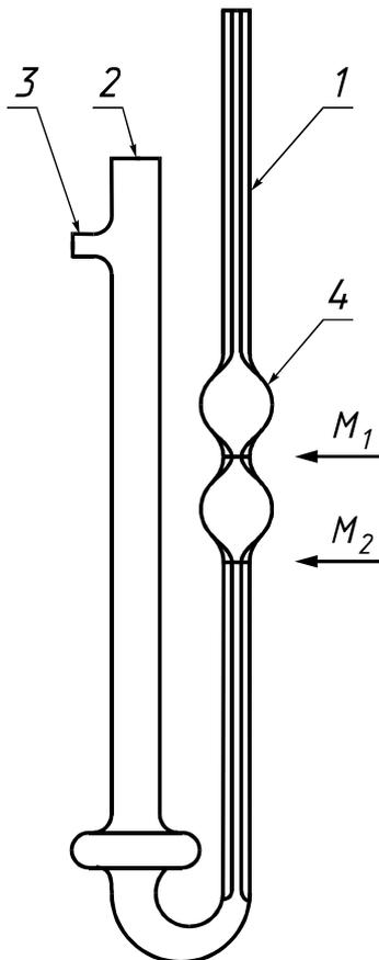
Рисунок А.2 — Вискозиметр типа Пинкевича (ВПЖТ-4, ВПЖ-4)
