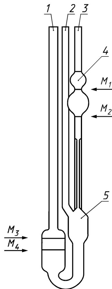
Рисунок А.4 — Вискозиметр типов ВПЖТ-1, ВПЖ-1 (БС/ИП/СЛ)
