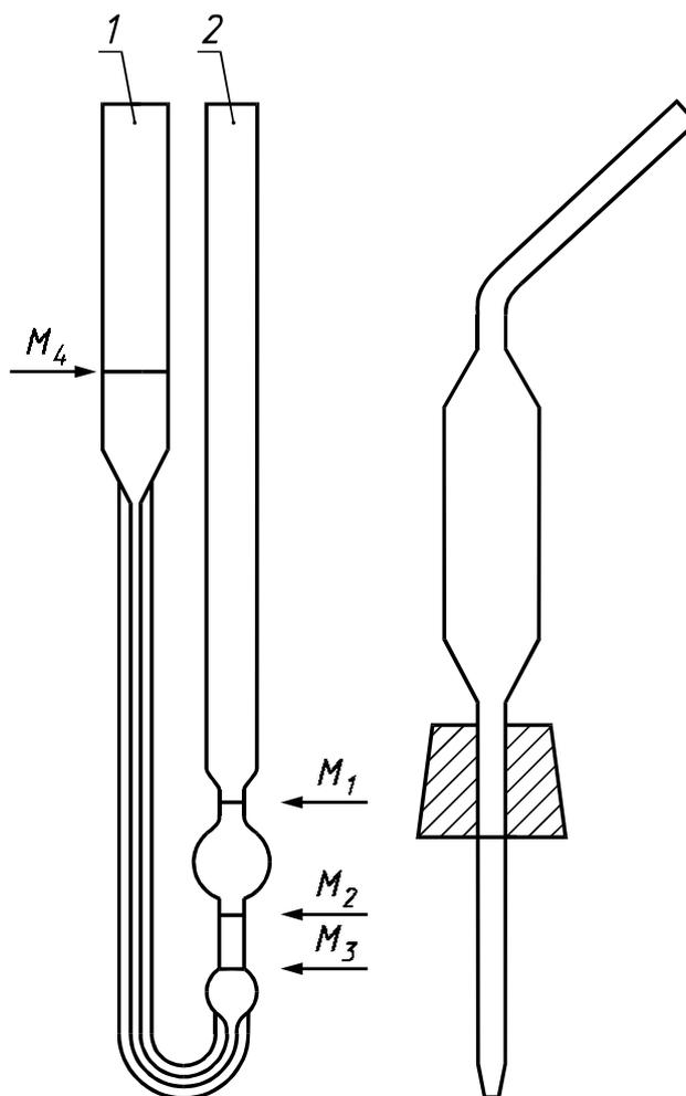
Рисунок А.7 — Вискозиметр типа БС/ИП/РФ
